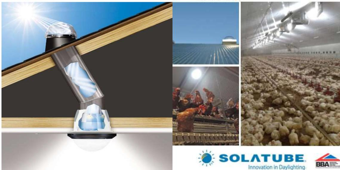
光管是由铝制反射管组成的，它将房屋外部的光线反射到室内。它们是一种替代方法，当窗户不能安装时，例如有通风系统时或在极端气候条件下，也就是温度条件不允许开窗-例如在炎热的气候条件下。
